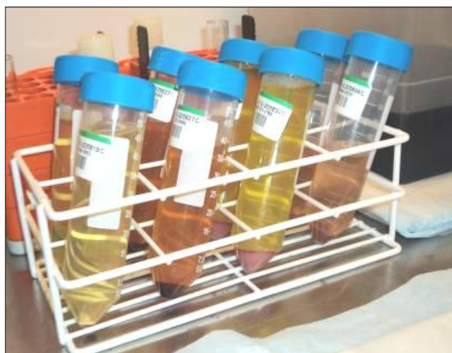
Figur 6. Til venstre centrifugerør efter centrifugering med prædicipat og til højre afhældning af supernatant.
